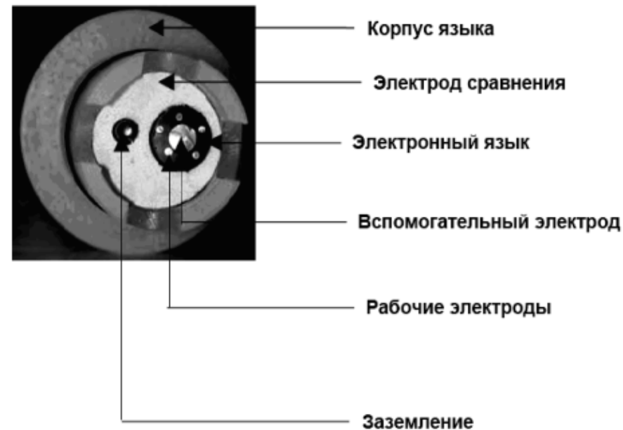
Конструкция первого вольтамперометрического электронного языка
